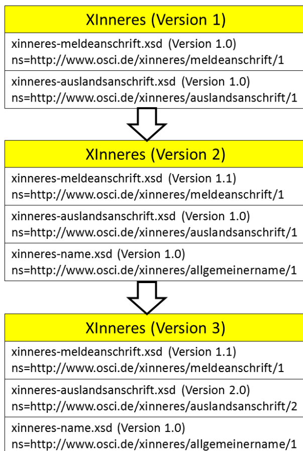
Abbildung 1.3. Fiktive, beispielhafte Entwicklung des XInneres-Basismoduls
